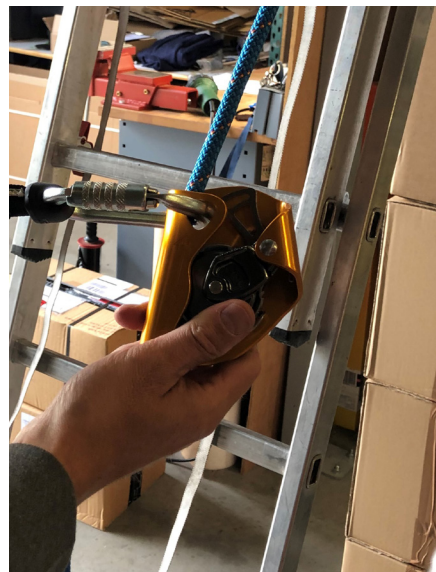
7. Gebruik valstop (ASAP) op leeflijn
