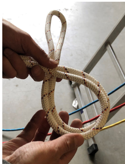
6. Het maken van een acht knoop (back-up knoop)
