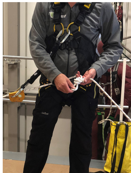
3. Trek eerst de schouderbanden aan, daarna de beenlussen en controleer of alle beenlussen goed zijn afgesteld
