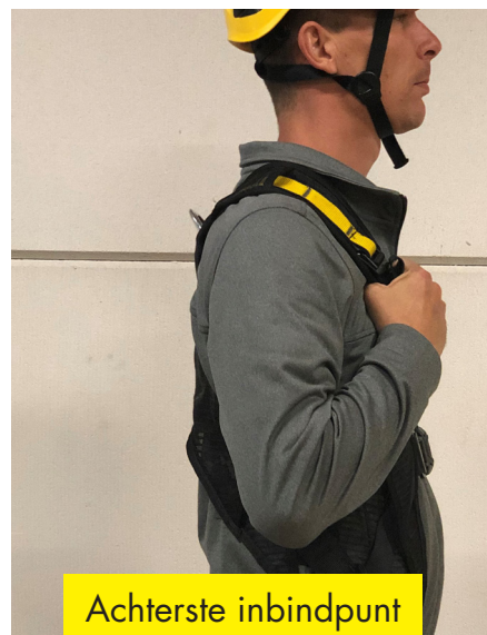
4. Controleer of het complete harnas goed is afgesteld
