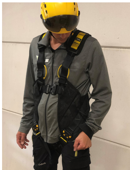
3. Trek eerst de schouderbanden aan, daarna de beenlussen en controleer of alle beenlussen goed zijn afgesteld
