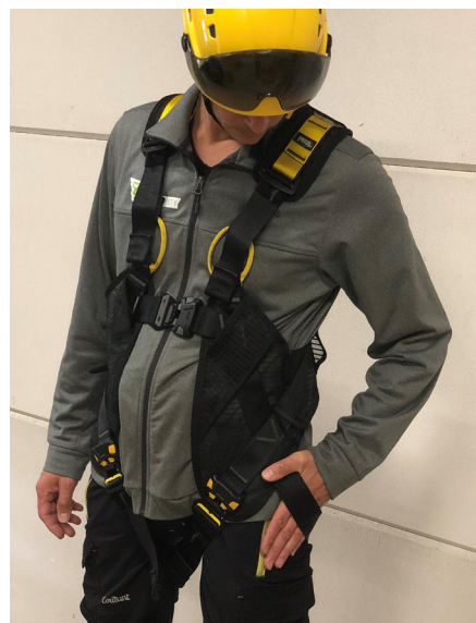
3. Trek eerst de schouderbanden aan, daarna de beenlussen en controleer of alle beenlussen goed zijn afgesteld
