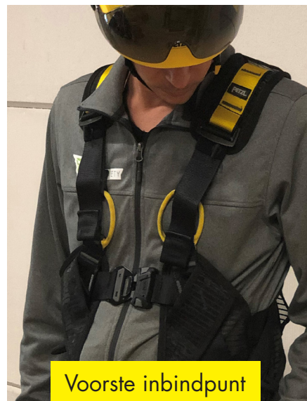
4. Controleer of het complete harnas goed is afgesteld
